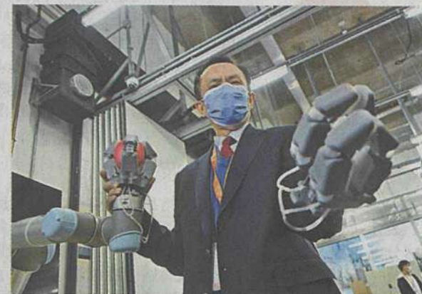
「物流機械人研究中心」研發的柔軟機械手臂，可夾起貨物及進行分類。李睿哲攝
