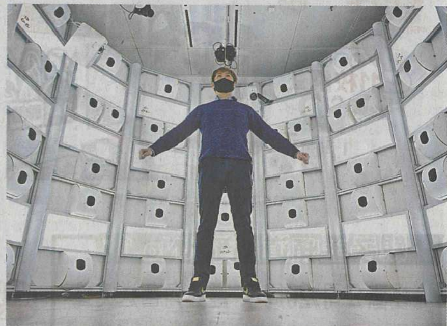
「博智感知交互研究中心」的自動製衣系統設有七十四個鏡頭，能在萬分之二秒內掃描人體，並傳送數據至製衣機，只需兩小時就有製成品。李睿哲攝
